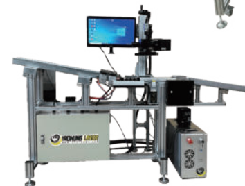
輸送帶+電腦視覺定位 Conveyor belt+computer vision
